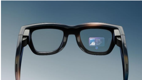
그림 2. LCoS가 적용된 Meta Ray-Ban Display
